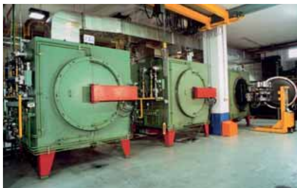
Modernste Nitrier- und Nitrocarburieranlagen mit einer Kapazität von 1500 kg je Anlage
